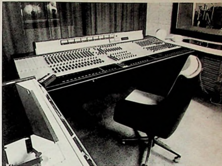
De nieuwe Cadac regeltafels. Links op de voorgrond de 8-sporen Ampex recorder. Achter de gordijnen staan 4 weergevers. Geheel rechts de grote studio.
