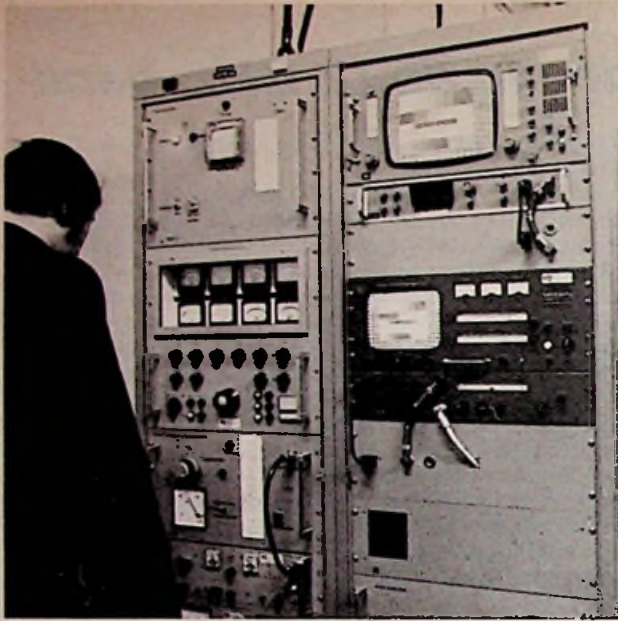
Meetek en beeldmonitor bij het Westberlijnse experiment voor kleurentransmissie op 12 GHz.
